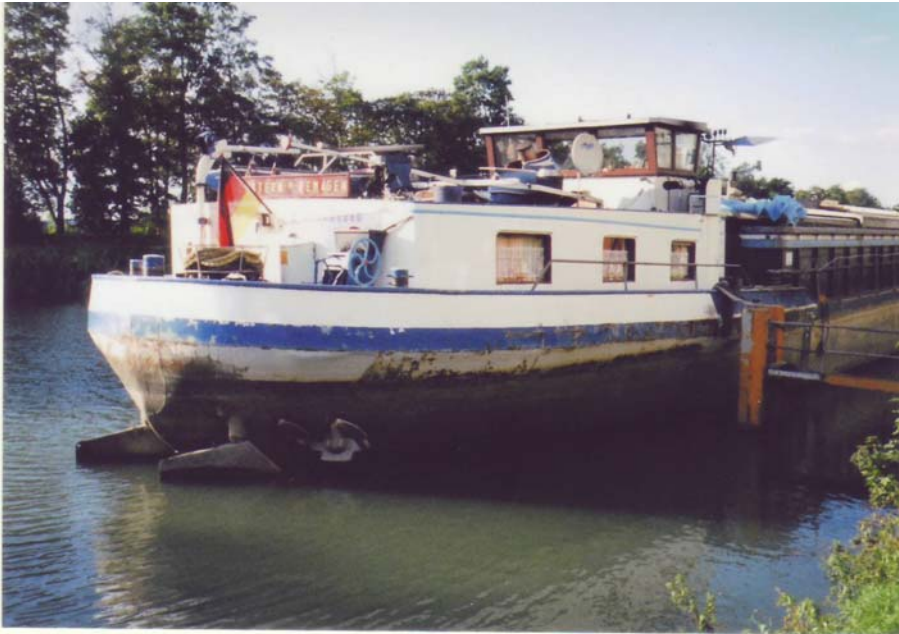
M/S 3 Seestern aus Remagen, 5. September 2010: Auf dem Achterdeck 30 ist hinterm Steuerhaus der Wohnbereich. Der Gangbord 6 liegt hoch überm Wasser: Der Schiffsführer wartet auf Ladung.
